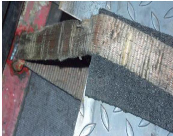
Abb. 31: Ablegereifer Gurt mit Antirutschmatte als Kantenschutz
