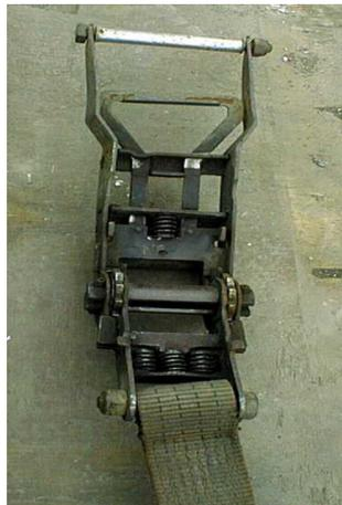
Abb. 18: Verformtes Spannelement
