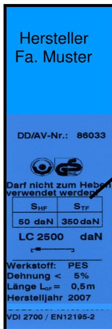
$S_{TF} = 350$  daN gibt die Vorspannkraft an, die mit dem Spannelement bei normaler Handkraft in das Zurrmittel eingebracht werden kann.
